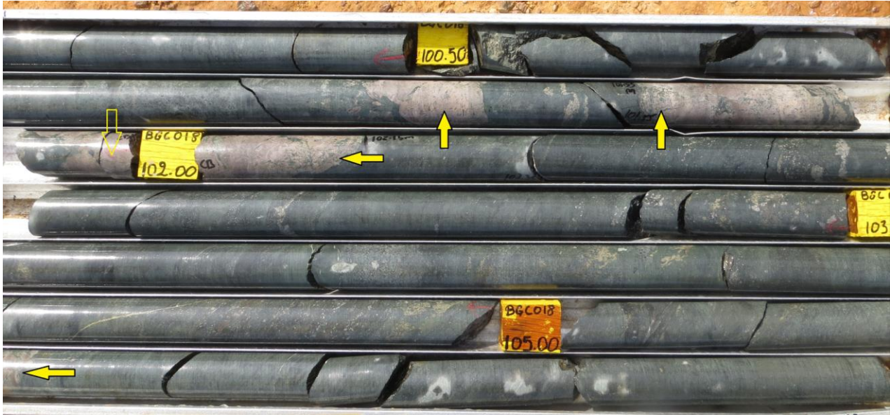
Abbildung 1: Massive Kasseriterzgänge in NQ-Bohrkernen aus der Bohrung BCG018 (die gelben Pfeile zeigen die rosa-braunen Kasseriterzgänge an)
