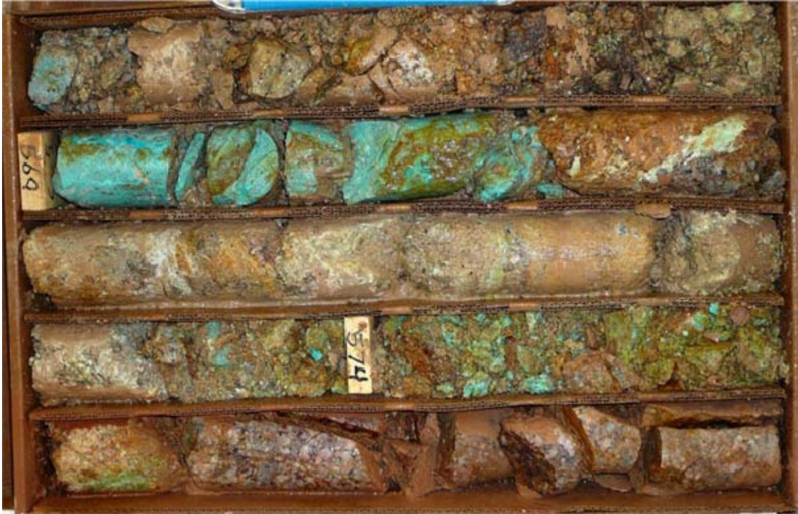
Foto 1: HQ-Bohrkerne, die im Rahmen des jüngsten Bohrprogramms beim Kupferprojekt Florence gewonnen wurden.
