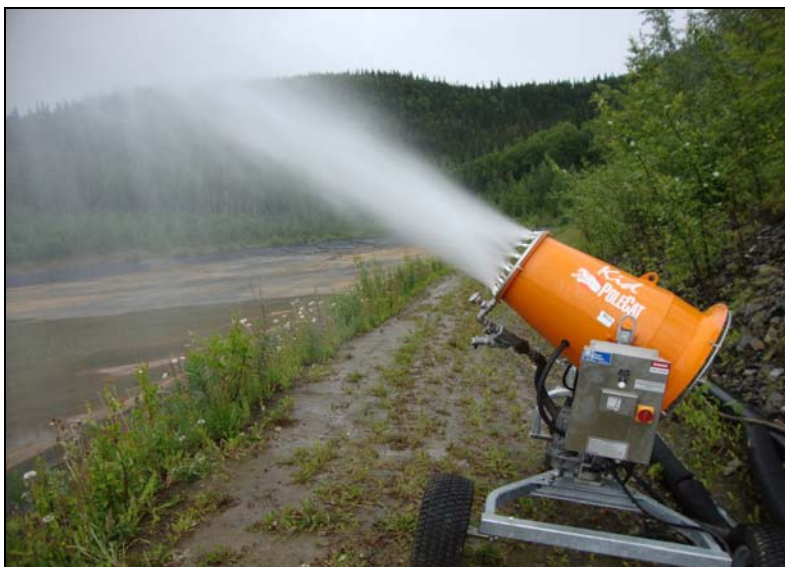
Abb. 4: Evaporationsturbine auf dem Abraunteich
