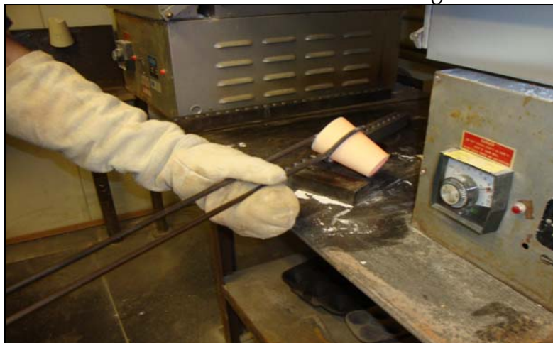
Abb. 6: Feuerprobung um die Lagerbestandsgrade zu bestimmen
