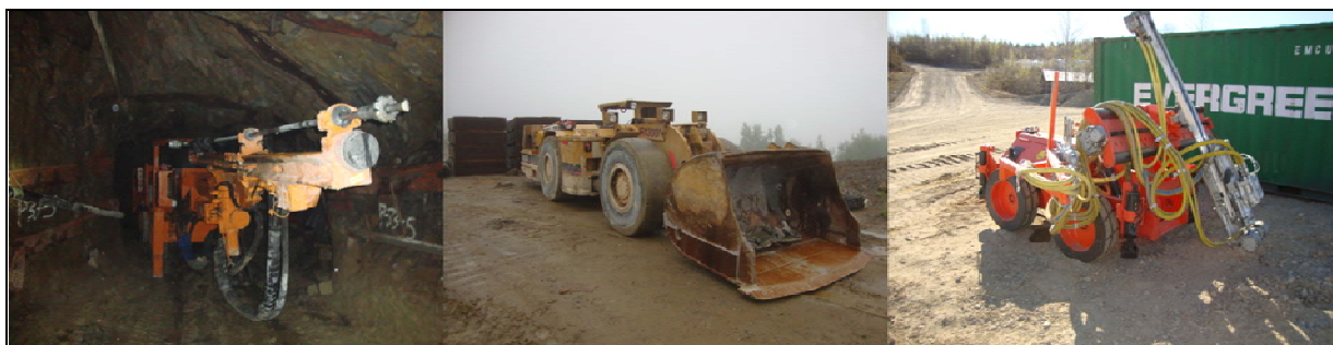
Abb. 3: Minenausrüstung (L nach R: Einbaumjumbo, 4 yd 3 Scooptram, LH Bohrer)
