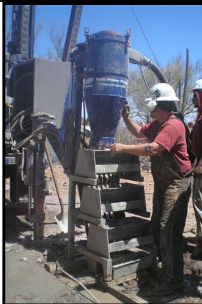
Abbildung A2: Bohrungen mit dem Reverse Circulation Bohrgerät Prospecter II. Probenentnahmen beim Konzessionsgebiet Don Luis in Sonora, Mexiko erfolgen sowohl im trockenen (links) als auch im feuchten (rechts - beachten Sie den Spalter) Zustand.
